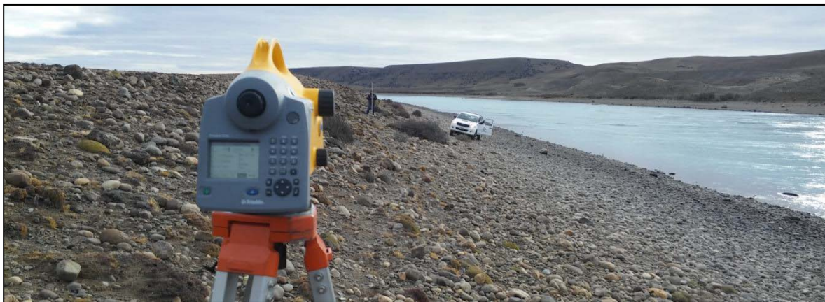
Figura 18: Ejecución de Nivelación Geométrica Margen Derecha río Santa Cruz NK, Perfil 42 Ampliación
